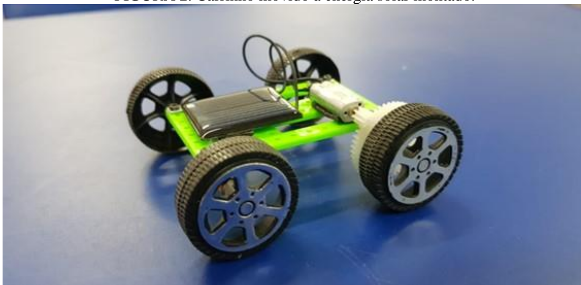
FIGURA 2. Carrinho movido à energia solar montado.
