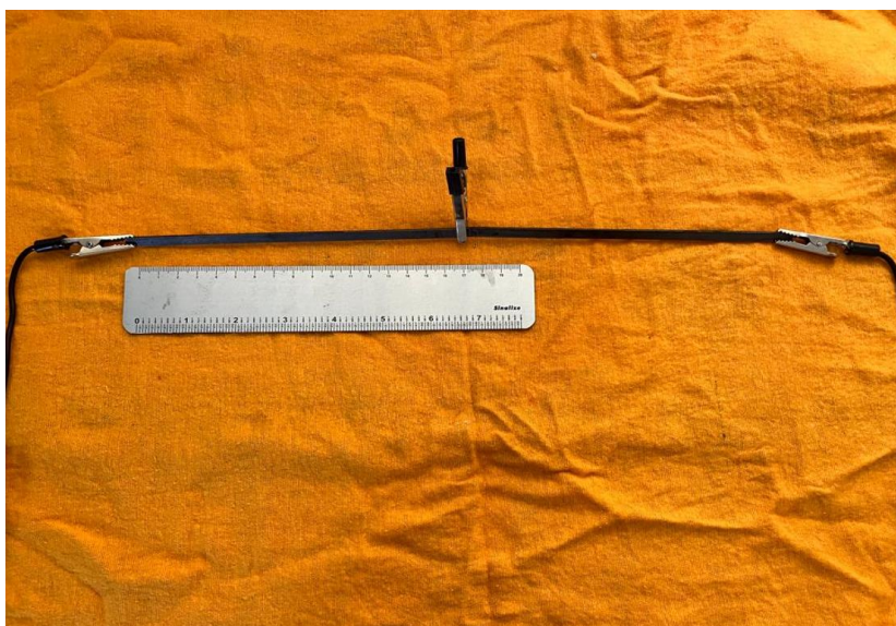
Figura 1: Configuração com as duas unidades de resistência de grafite em série, como se aumentássemos o comprimento. Fonte: Autores: (2023).
