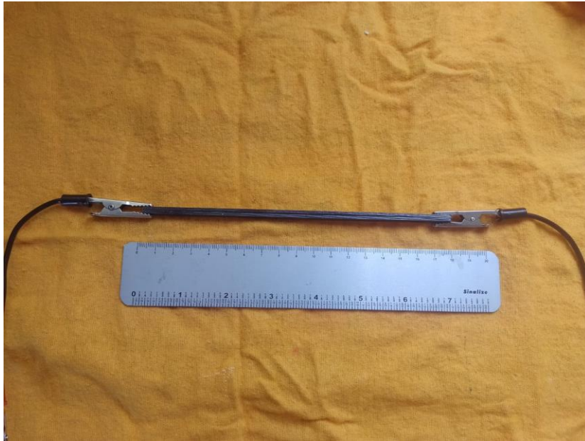
Figura 2: Configuração com as duas unidades de resistência de grafite em paralelo, como se aumentássemos a área de secção transversal. Fonte: Autores: (2023).
