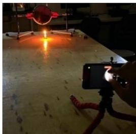
FIGURA 6. Aparato para o efeito Schlieren.
