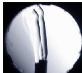
FIGURA 7. Ondas de pressão com o efeito Schlieren.
