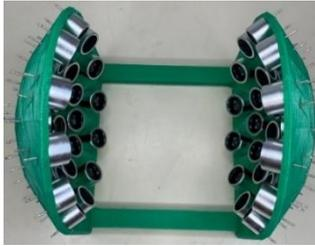
FIGURA 4. A base do levitador com os transdutores
