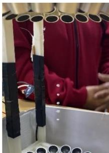
FIGURA 2. Levitador acústico levitando bolinhas de isopor.
