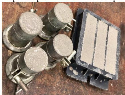
FIGURA 4. Corpos de prova imediatamente após a moldagem.
