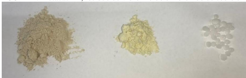
FIGURA 2. Metacaulim, resíduo de vidro moído e hidróxido de sódio em lentilhas.
