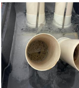
Figura 03 - Percolação observada durante o ensaio.
