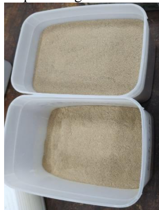
FIGURA 2. RCD após secagem em estufa e peneiramento
